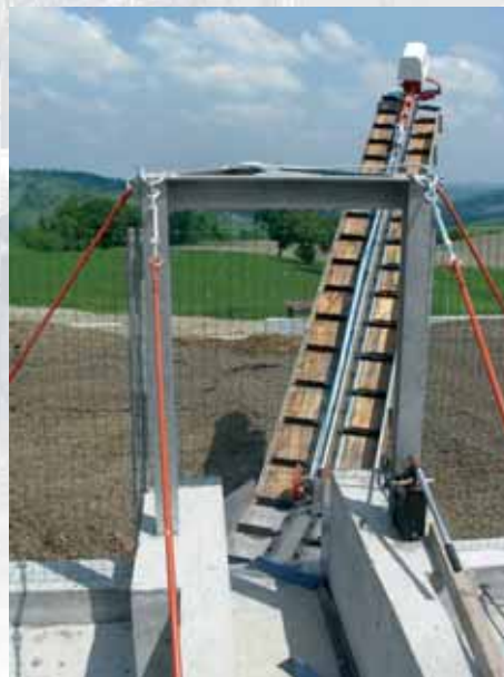
Elevatore a circuito chiuso orientabile. Lunghezze fino a 10 metri.
