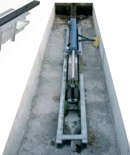
Gruppo di traino R.S.V. con cilindro e guide in polizene autolubrificanti.
